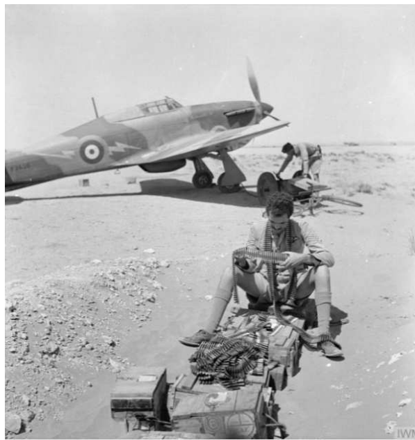
Terrain de Sidi Barrani, en Égypte - Le sergent pilote F. DEAN du « 274 Squadron » examine les bandes de munitions avant leur mise en place. À l'arrière-plan, l'un des membres de l'équipage au sol met en place un chariot-accumulateur pour la mise en marche du moteur. (IWM)
